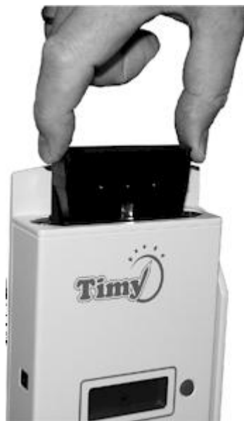
Halterung samt Batterien herausziehen
